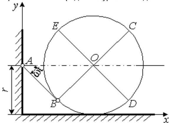
7. Стержень  $AB$  длиной  $l$  скользит концом  $B$  по вертикальной стене, а концом  $A$  – по полу, при этом  $V_A = V_B = const$ . Определить уравнения движения и уравнение траектории точки  $M$ , если при  $t = 0$  стержень вертикален. Вписать правильный ответ.
